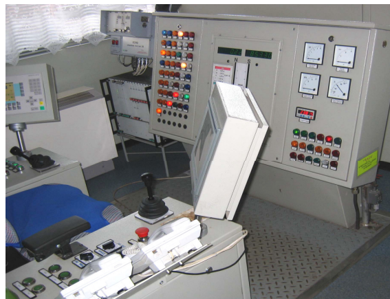
Fot. 10. Stanowisko maszynisty wyciągowego w nowoczesnych maszynach wyciągowych
