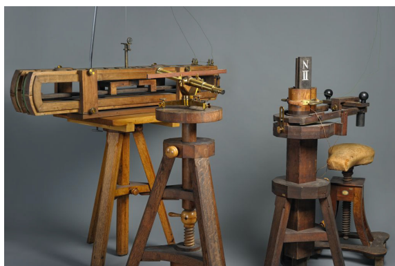
Fot. 8. Telegraf Gaußa i Webera w Muzeum Fizycznym w Getyndze. Model zbudowany na zlecenie Webera w latach 1848–1873. Po prawej cewka nadawcza, po lewej cewka odbiorcza wg [12]
