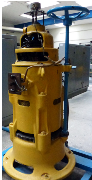
Rys. 9. Przetwornica elektromaszynowa wyprodukowana w fabryce w Żychlinie w okresie międzywojennym, (zdj. B. Drak)
