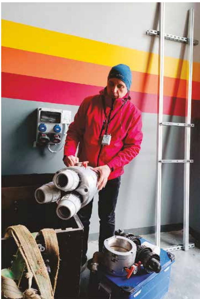
Głowica do tłoczenia trzech kabli jednożyłowych, foto: Hanna Szemiot
