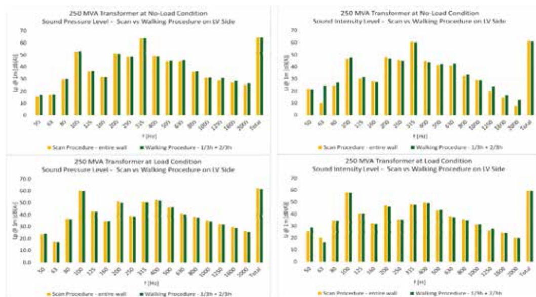
Rys. 3. Porównanie pomiarów hałasu przeprowadzone przy użyciu dwóch różnych procedur pomiaru ciągłego „walk-along” vs. „scanning”
