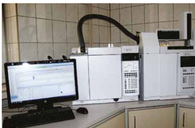
Rys. 8. Chromatograf gazowy amerykańskiej firmy Agilent typu 7890A
