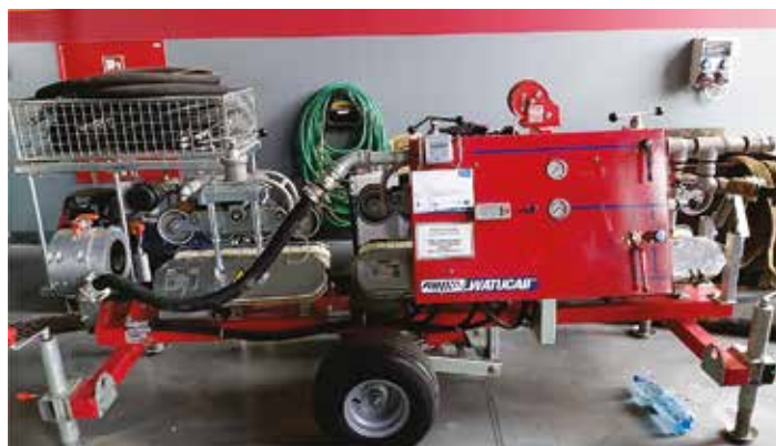
Zdjęcie maszyny do tłoczenia kabli, foto: Hanna Szemiot
