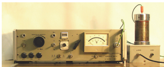
Rys. 10. Generator napięciowy udarów piorunowych 1,5 kV/6 kV i rezystancyjny dzielnik napięciowy
