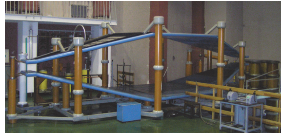
Rys. 7. Symulator impulsowego pola elektromagnetycznego [13]
