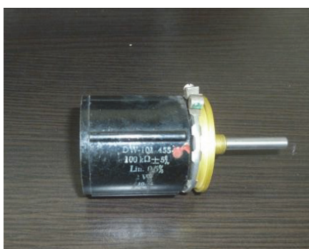
Fot. 14. Potencjometr precyzyjny 10-obrotowy DW [9]
