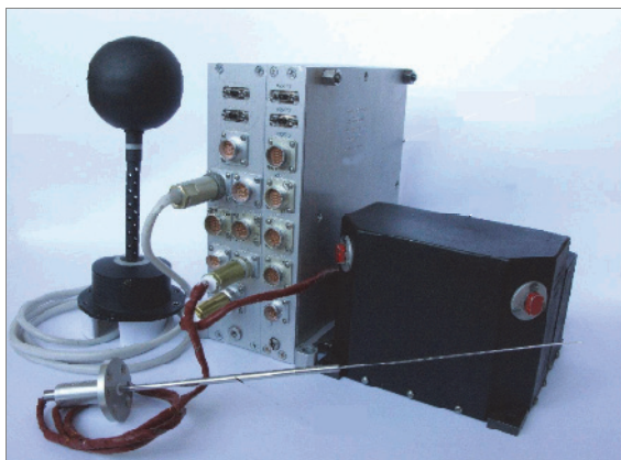
Fot. 13. Zestaw urządzeń naukowych "Potencjał" satelity "Sich-2" do badania parametrów elektromagnetycznych przestrzeni kosmicznej
