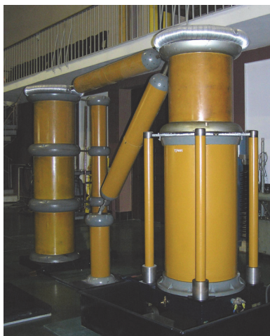
Rys. 6. Źródło napięcia stałego 300 kV w układzie Greinachera
